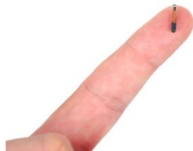
Transponder (RFID-Mikrochip in der Grösse eines Reiskorns)
